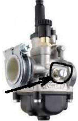
*De stationair stel schroef (ralenti) dient om het regime van de motor bij stilstand te regelen.*
