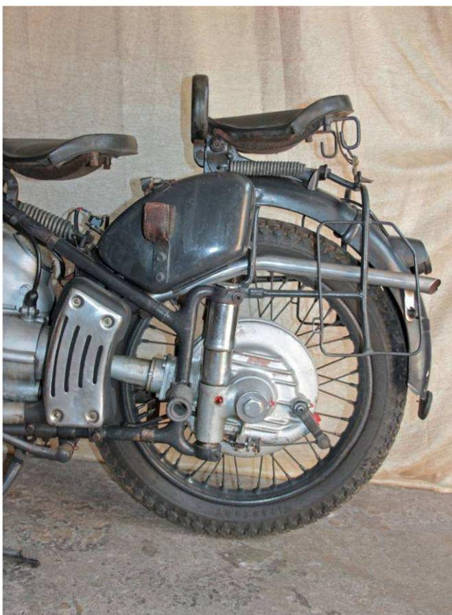
De wielen zijn met 3 bouten makkelijk los te halen en het verwisselen, ook van achter naar voor, gebeurt in een handomdraai. Al met al is het een zeer degelijk uitgevoerde motorfiets. De motor was verder voorzien van gigantische 27 cm remtrommels. Beide remtrommels zijn voorzien van koelribben. De achter- en de voorremtrommel zitten rechts. Later werd de achterremtrommel naar links weggewerkt in het cardanhuis.
